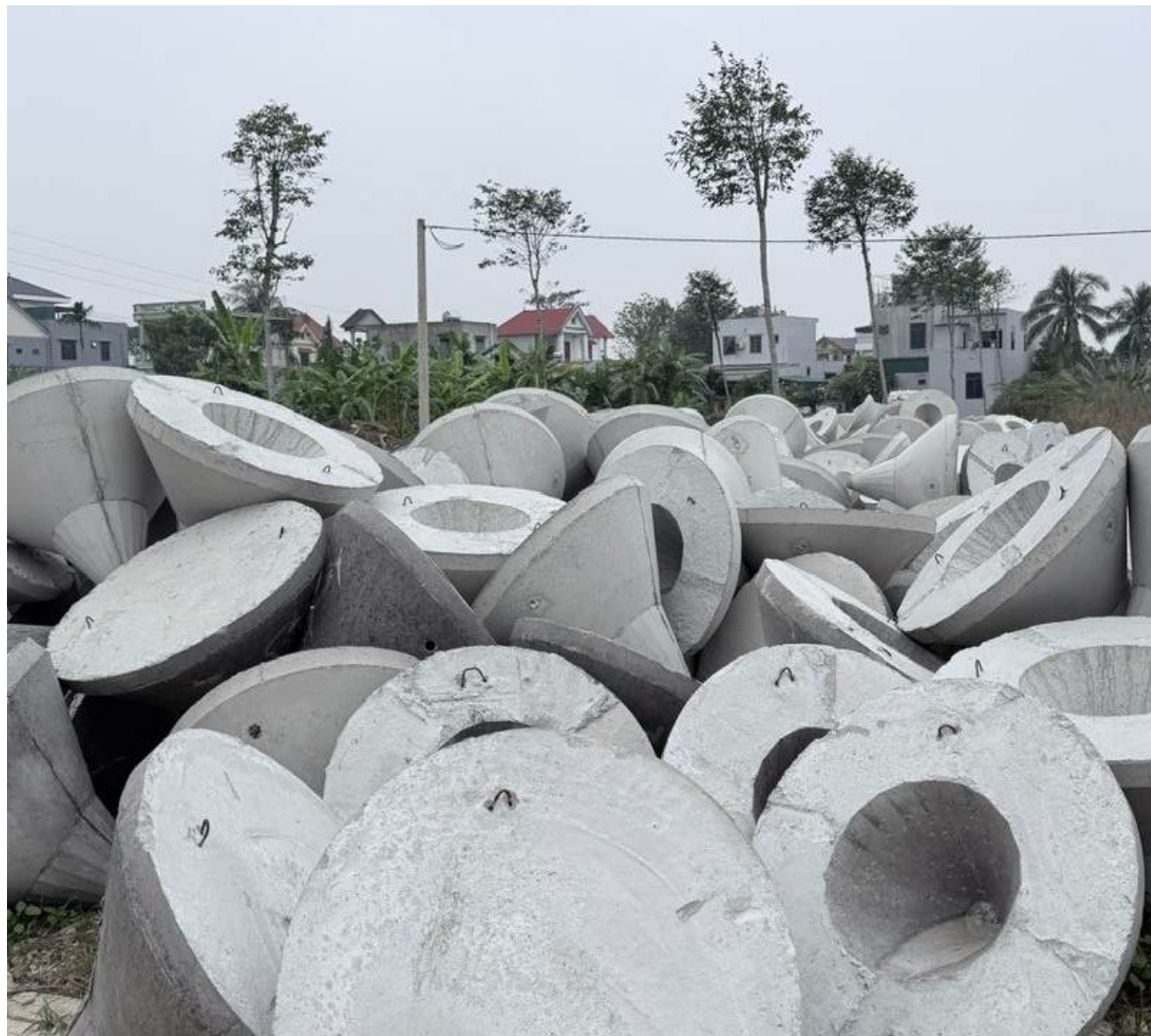
Cấu kiện VTop-block đúc sẵn tại bãi sản xuất
